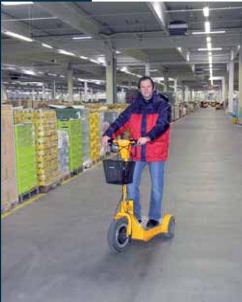
Dreirädriger elektrisch betriebener Roller für den innerbetrieblichen Personenverkehr und kleinere Kommissionieraufgaben. Durch eine individuelle Anpassung kann das Fahrzeug auf Ihre Bedürfnisse optimal abgestimmt werden. Höchstgeschwindigkeit bis 21 km/h . Das Fahrzeug inclusive Batterien ist wartungsfrei.
