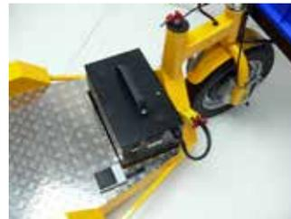
Option Wechselbatterie ( nur mit 22 Ah möglich )
