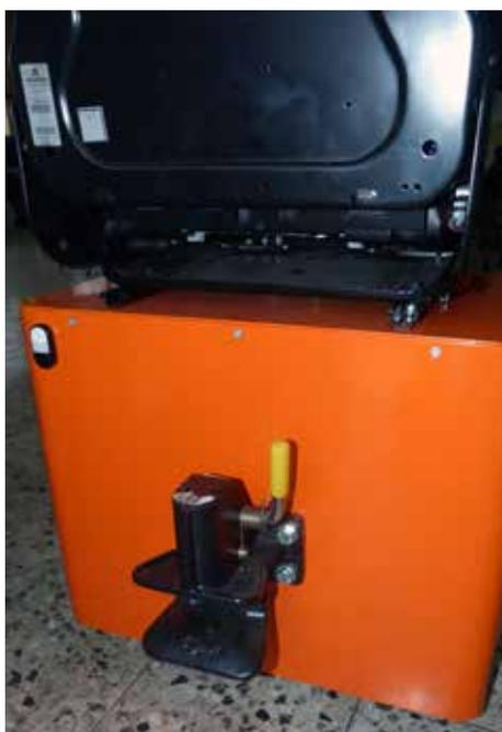
Elektrisch betriebenes Schub-Kommissionierfahrzeug mit Fahrerstand, bei dem es möglich ist, den Kommissioniertrolly vom Schubgerät durch eine Kupplung zu trennen, um den Kommissioniertrolly bei Bedarf zu wechseln. Die Trollys können auf Kundenwunsch angepasst werden, jedoch darf die maximale Zuladung von 300 kg nicht überschritten werden.
