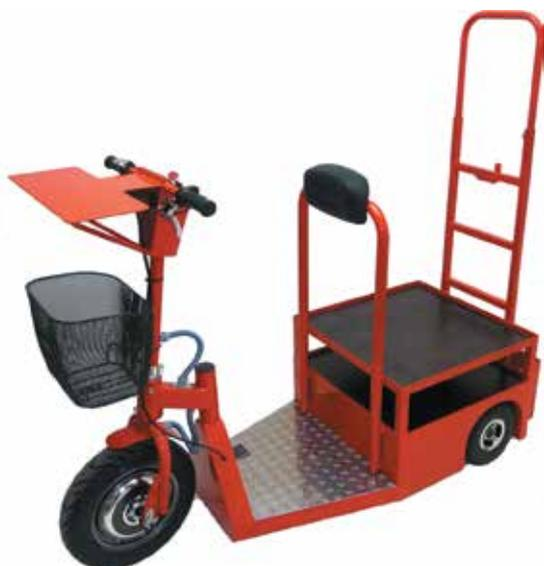
Dreirädriger elektrisch betriebener Roller für den innerbetrieblichen Personenverkehr und kleinere Kommissionieraufgaben. Durch eine individuelle Anpassung kann das Fahrzeug auf Ihre Bedürfnisse optimal abgestimmt werden. Höchstgeschwindigkeit bis 14 km/h . Das Fahrzeug inclusive Batterien ist wartungsfrei.
