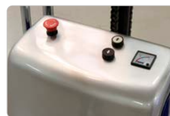
Betjeningspanel med nødstop og batteriindikator
